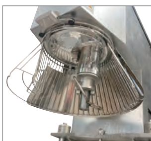
攪拌エリアはステンレス製
