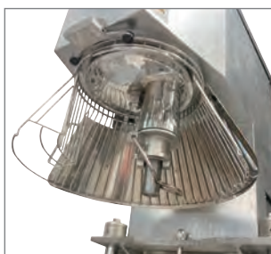
攪拌エリアはステンレス製
