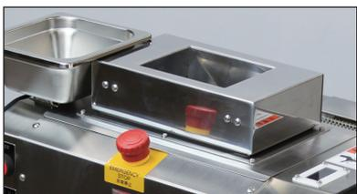
危険を感じてホッパーを押すと、非常停止がかかる構造の安全装置を採用。生地がローラーに引っ張られて手指がホッパーに触れても非常停止がかかります。
